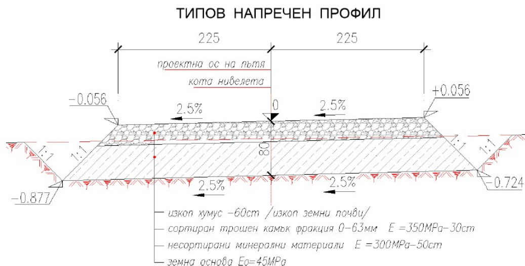
Фигура. 1.2.1-1. Типов напречен профил на пътища
