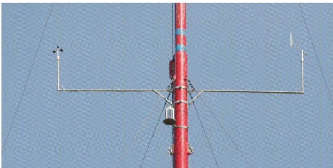
Фигура 3.1.1-3. Разположение на анемометър и сензор за посока на вятъра на 40 m над земната повърхност
